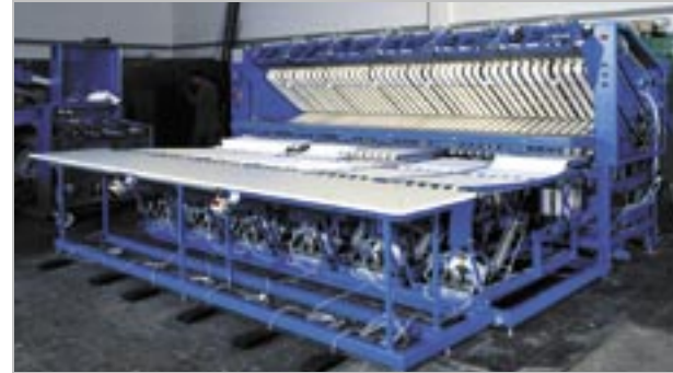
▲ ▼ Piegatrice a 6 nastri per lavanderie di grandi dimensioni: utilizzando l'inverter J7 è possibile fare scorrere ogni nastro ad una velocità diversa.
